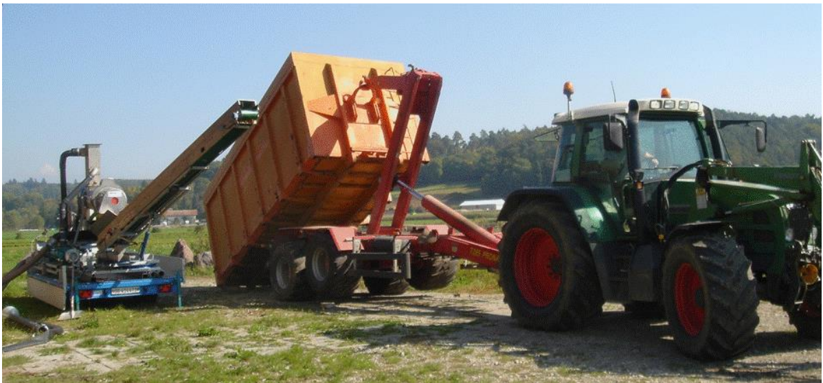
Abbildung 19: Traktor mit Hakenliftgerät beim Abladen der Mulde. Links ist der fahrbare Separator zu sehen (HERSENER).
