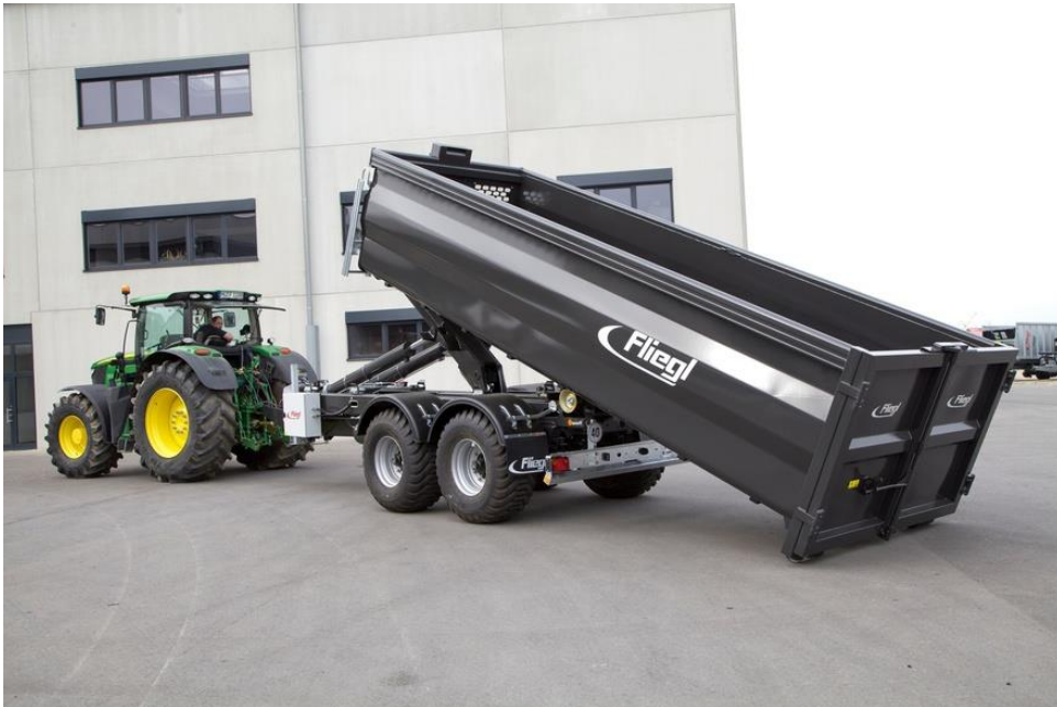
Abbildung 14: Traktorgezogenes Hakengerät mit befahrbarer Abrollmulde
