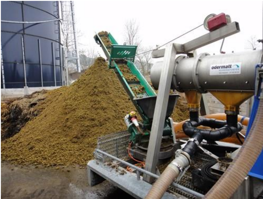
Abbildung 12: Mobile Siebpressschnecke für den überbetrieblichen Einsatz (HERSENER)
