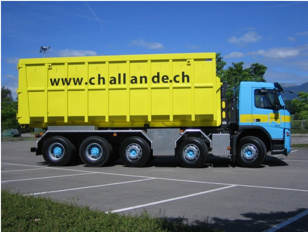
Abbildung 16: 5-Achs-Lastwagen mit Abrollmulde, 40 t
