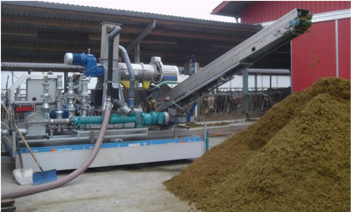
Abbildung 18: Bild der fahrbaren Separieranlage (HERSENER).
