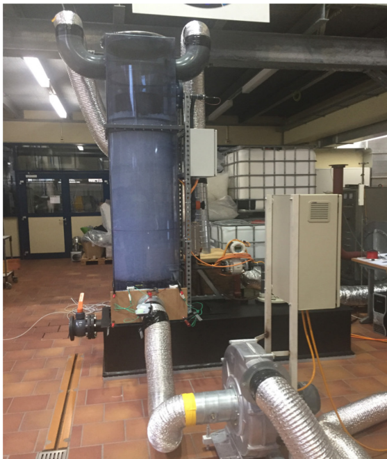
Abbildung 13: Versuchsanlage der ZHAW (2017), mit Absorptionssäule in Blau.
