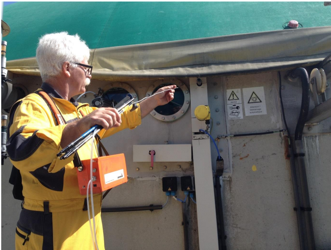
Abbildung 3. Oester Messtechnik GmbH beim Messen der Methankonzentrationen an den Schaugläsern eines Fermenters mit einem Flammenionisationsdetektor.
