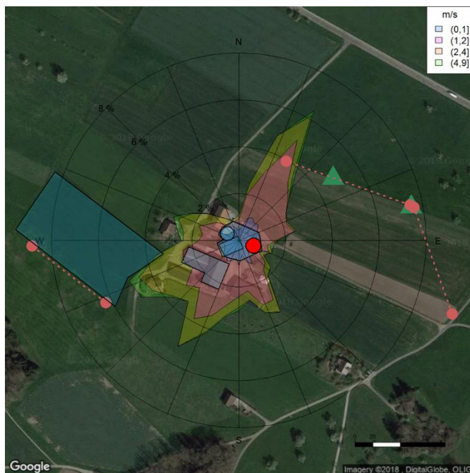
Abbildung 1. Luftbild der Biogasanlage CH-01. Eingezeichnet in hellroten Kreisen sind die Standorte der GasFinder mit deren Retroreflektoren. Einer befindet sich im Südwesten der Anlage, zwei weitere im Nordosten und Osten der Anlage. Die gestrichelten Linien zeigen die Messpfade an. In grünen Dreiecken sind die beiden Ultraschallanemometer eingezeichnet, wobei Sonic1 im Nordosten und Sonic2 im Ostnordosten steht. In einem blauen Overlay sind die Methanquellen Weide, Stall und Biogasanlage eingezeichnet. Die Biogasanlage ist weiter unterteilt in Festlager, Güllelager und in Rot der Nachgärer. Zusätzlich ist Verteilung der vor Ort gemessenen Windrichtung (10° Intervalle) und Windgeschwindigkeit (Einteilung: 0-1 m/s, 1-2 m/s, 2-4 m/s und 4-9 m/s) eingezeichnet.
