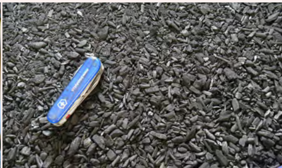
Foto 5.2: Biokohlen sollten eine regelmässige Granulometrie und tiefe Schadstoffgehalte aufweisen; beides wird im Label «EBC» geprüft. Vom BLW werden nur Label-Biokohlen zugelassen.
