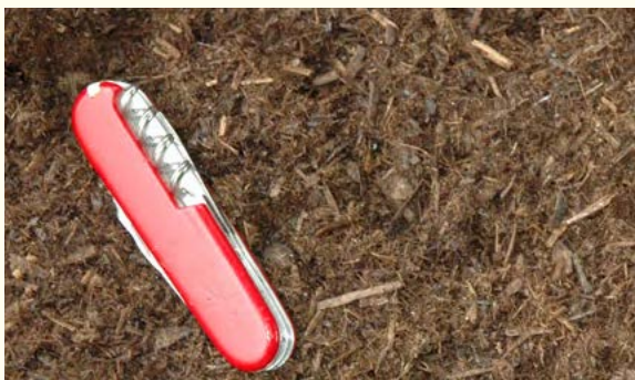
Foto 2.1: feste Vergärungsprodukte (hier Gärmist) weisen immer eine stark faserige Struktur auf, weil Lignin anaerob nicht abgebaut wird.
