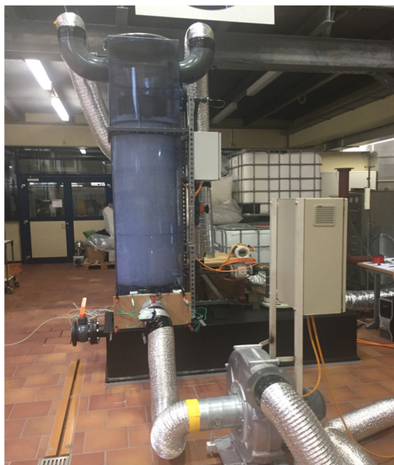
Figure 13: Installation expérimentale de l'Institut ZHAW (2017), colonne d'absorption en bleu.
