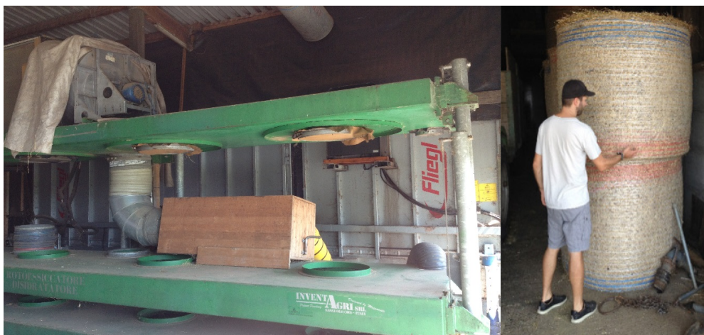
Figure 14: Séchoir de balles de foin d'Inventa (à gauche) à l'exploitation Natur Energie et balles de foin écologiques séchées (à droite).
