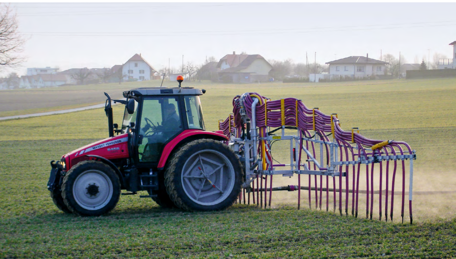
Abbildung 18: Verschlauchung ab Druckfass am Feldrand wirkt Bodenverdichtung entgegen. (Bild: Thomas Schnyder)
